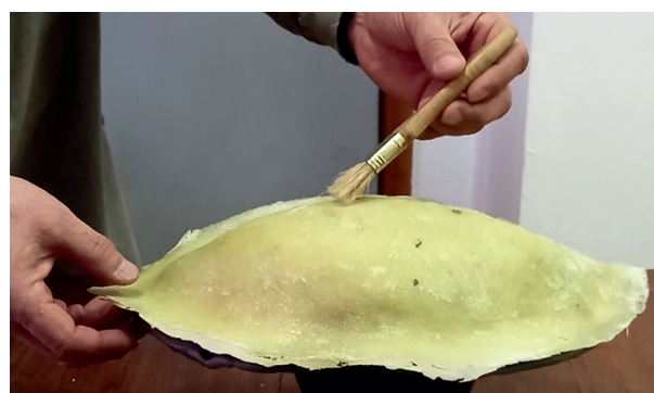
Сурет 12 - Көп қабатты силиконның үстіне шыны талшықты жабын қолданылады
