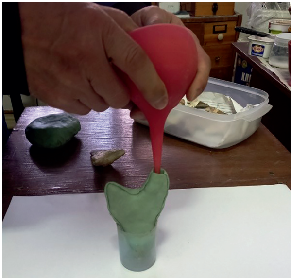
Сурет 7- Дайын матрицаға массаны құйылуы Figure 7 - Pouring mass into the finished matrix
