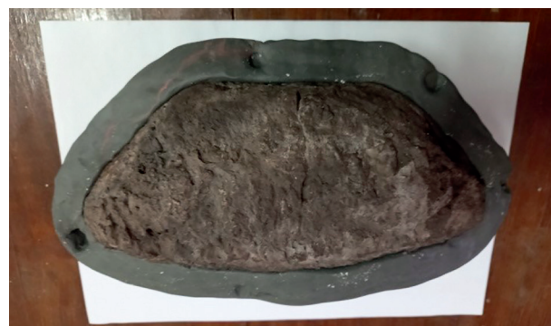
Сурет 10 - Пластилиннің шеттері жеке пішіндердің периметрі бойынша орналастырылған Figure 10 - The edges of plasticine are placed along the perimeter of individual shapes
